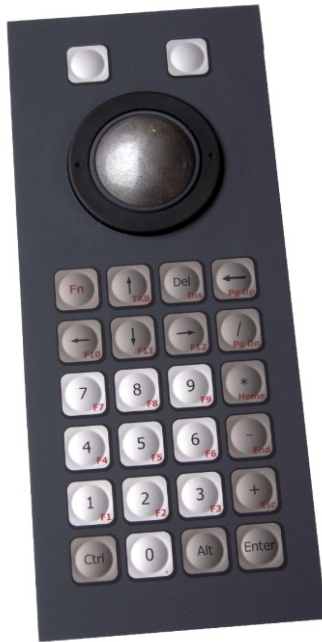
Panel mount version KBMT26F1 Dim : 85 x 205 x 33 mm Weight : 0,2 kg
