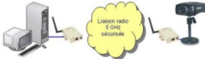
REPLACEMENT D'UN CABLE RJ45 ENTRE DEUX EQUIPEMENTS
