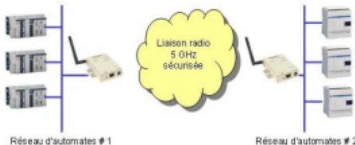
INTERCONNEXION DE DEUX RESEAUX ETHERNET
